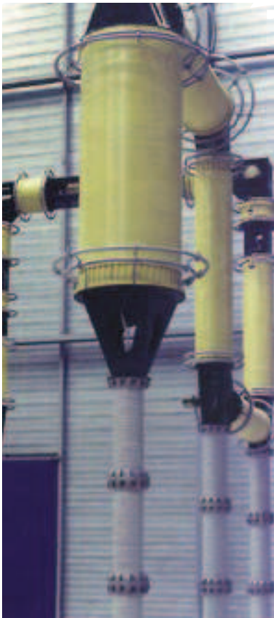
Рис.23. Реактор для комплексных испытаний выключателей (максимальный ток 32 кА, индуктивность 0,318 – 353,6 мГн, класс напряжения до 1600 кВ)
