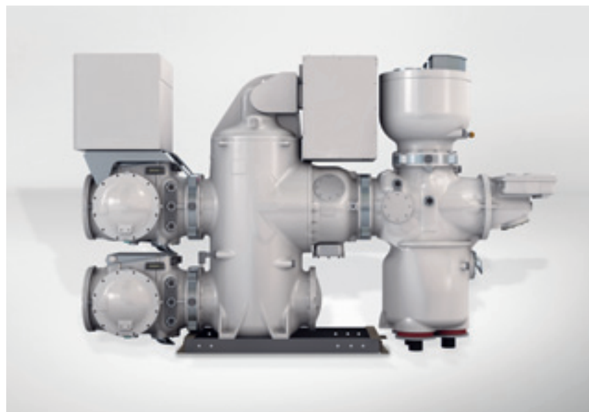
Компактность благодаря трехполюсной изоляции: установка типа 8DN8 на напряжение 145 кВ, ячейка КРУЭ с двойной сборной шиной и модулем кабельного ввода
