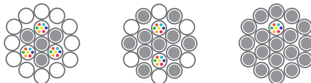
Конструкция ОКГТ с трубкой, расположенной с краю
