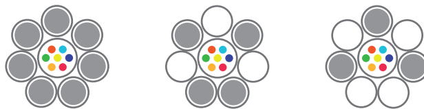
Конструкция ОКГТ с трубкой, расположенной по центру
